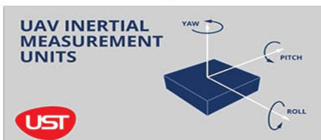
يسمح الجيروسكوب بمتابعة حركة الطائرة على جميع المحاور بما في ذلك كشف درجة الميل. وتعد الجيروسكوبات أداة متعددة الاستخدامات لقياس الاتجاه والحفظ عليه. وهذا مهم بشكل خاص للطائرات بدون طيار المستخدمة في التصوير الجوي. حيث تقتضي طبيعة عملها أن تظل مستقرة ومستوية لالتقطان أفضل الصور. ويكتشف مستشعر الجيروسكوب السرعة الزاوية في محاور الحركة الثلاثة (Yaw, Pitch, Roll).
