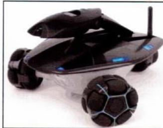
Ce qui lui permet de se déplacer, de s'orienter et de retrouver des objets. Il navigue de façon autonome grâce à un système de triangulation à rayons
